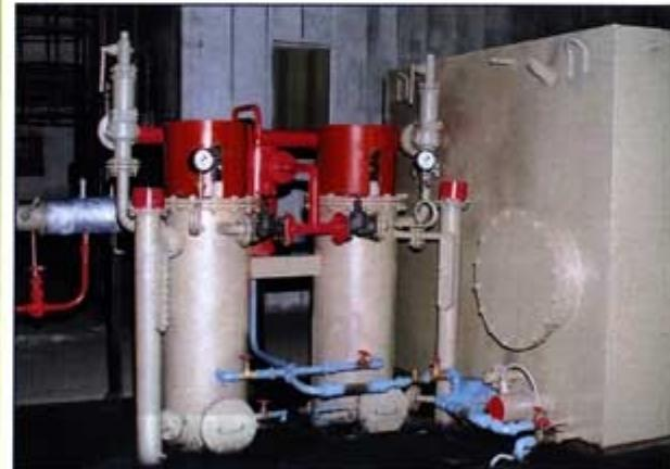
Парогенератор «ОЗНА-ЮГРА» предназначен для обеспечения технологических и бытовых нужд нефтепромыслов и буровых бригад. Установка вырабатывает пар давлением 0,2 МПа и температурой 160-170°C. Парогенератор используется в пищевой, химической, строительной промышленности, где в производственных процессах применяется сухой пар.
