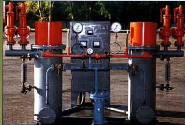
Предназначен для получения насыщенного пара или горячей воды и применяется для технологического теплоснабжения различных производственных и сельскохозяйственных объектов.
